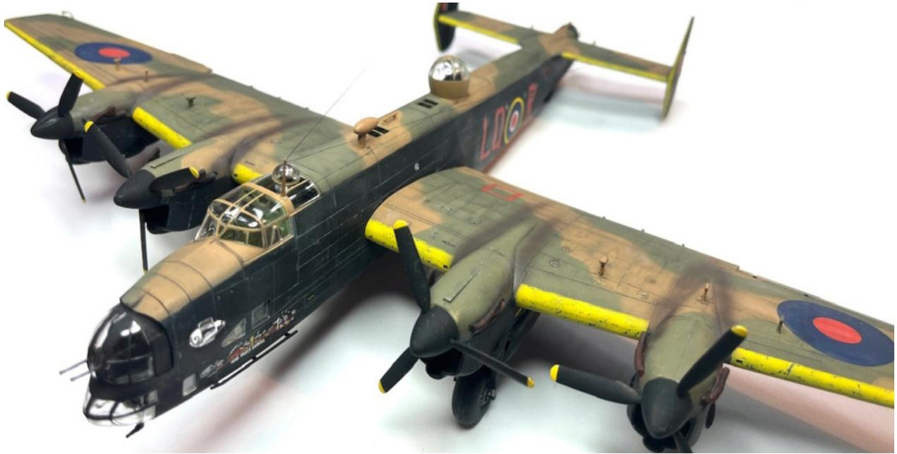
Bombardier lourd quadrimoteur britannique, conçu dès 1936, le Halifax entra en service actif en 1941 emportant 7 hommes d'équipage, entre 8 000 et 13 100 litres de carburant et chargeant environ 4 tonnes de bombes pour un poids maximum de 30,5 tonnes au décollage. Les missions de guerre duraient en moyenne entre 6 et 8 heures. Sa vitesse au sol était de 460 à 470 km/h et son plafond pouvait atteindre un peu plus de 20 000 pieds (6 100 m). Inférieur en performances au Lancaster
