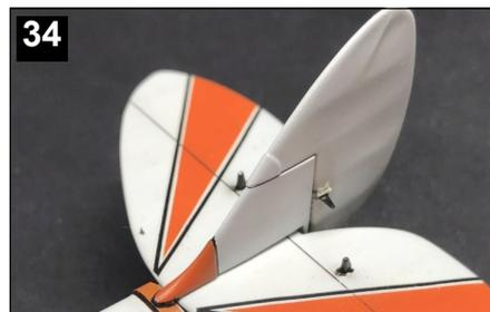
Quelques détails sont repris comme le renfort sur le dos du fuselage devant la dérive confectionné avec une bande découpée dans une
