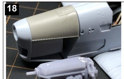
passage de commandes), l'habillage du compartiment suivis de la construction de la tôle guidant le flux d'air autour des cylindres (17 et 18)
