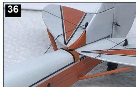
greffé le moteur (35), avant de tricoter avec la pose des multiples câbles de gouverne (36).
